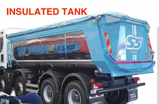
REAR TIPPER WITH FRONT CILINDER
